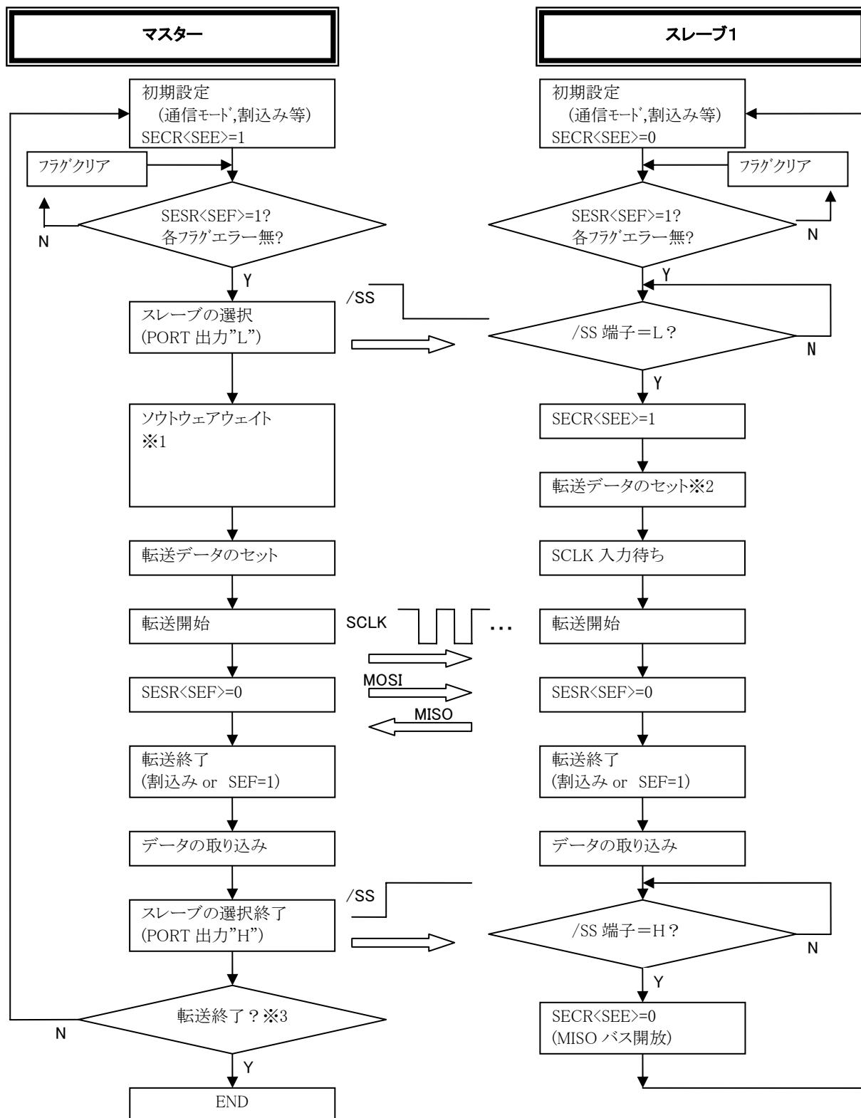
※1, マスターデバイスでのソフトウェアによるウェイトが必要となります。スレーブデバイスのセットアップ時間を十分考慮して、転送開始してください。
